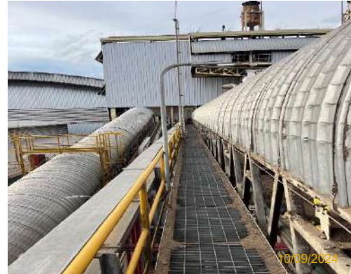
รูปที่ 2-15 การปิดครอบสายพานลำเลียงขนอ้อย
